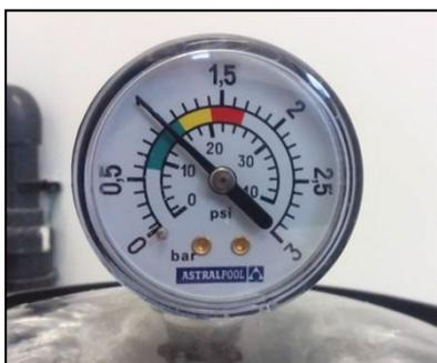
2 - Il est temps de laver et rincer le sable, l'aiguille du manomètre est sur le jaune
